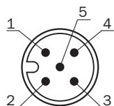
Schéma de raccordement UM18-21xxx6xxx UM18-21xxx7xxx Connecteur mâle M12, 5 pôles
