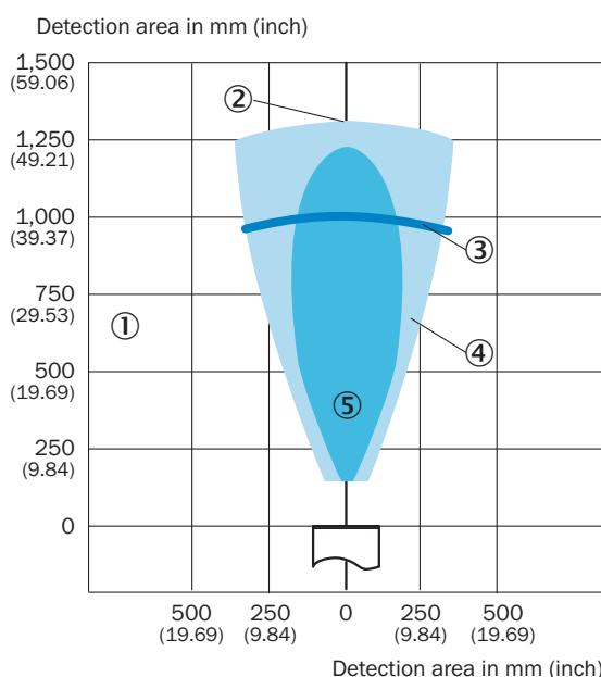
(1) plage de détection en fonction des propriétés de réflexion, de la taille et de l'alignement de l'objet
