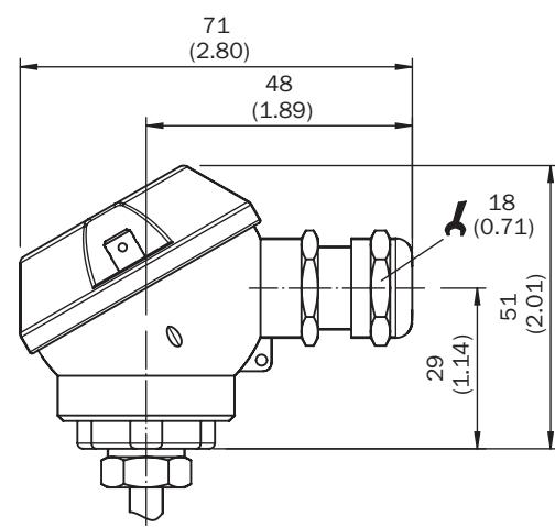
Mode de raccordement Entrée de câble M16 x 1,5, section de câble jusqu'à 0,75 mm<sup>2</sup>, signal de sortie Pt100
