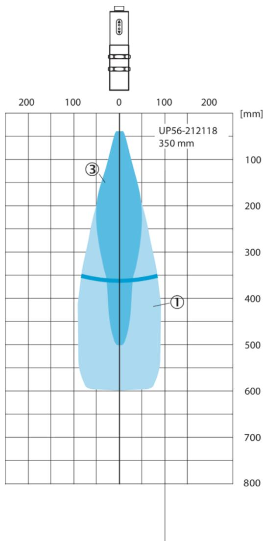
Lorsque les points ci-dessus se trouvent dans un cône d'émission, une détection fiable est garantie
