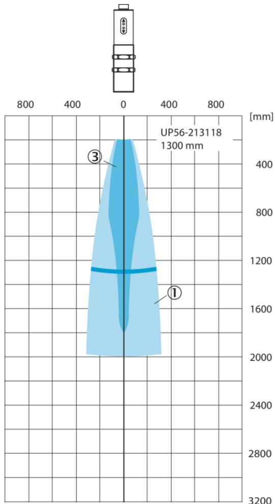
Lorsque les points ci-dessus se trouvent dans un cône d'émission, une détection fiable est garantie
