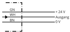
Diagramme de résolution Multitours, sortie de courant
