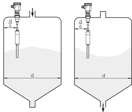
**Instructions de montage Orientation de l'écoulement des lames vibrantes**
