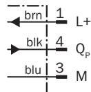
Schéma de raccordement Cd-045
