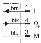
Schéma de raccordement Cd-045
