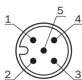
Schéma de raccordement UM30-21x111 UM30-21x114 Connecteur mâle M12, 5 pôles
