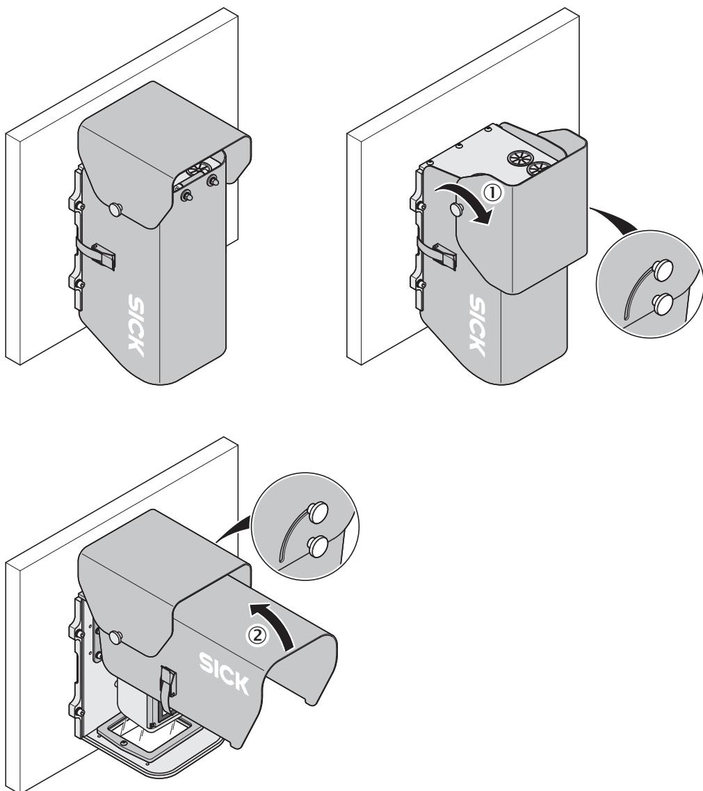
① Desserrer l'écrou moleté et faire basculer la protection anti-pluie (référence article : 2087690) vers l'avant au-dessus du boîtier de protection (référence article : 2087695)
