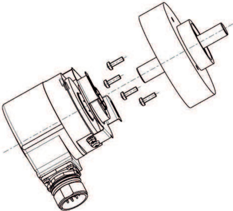
Le montage du support de palier s'effectue à l'aide des alésages de filetage frontaux ou d'un adaptateur à bride (réf. 2029162) ou d'une équerre de fixation (réf. 2029164).
