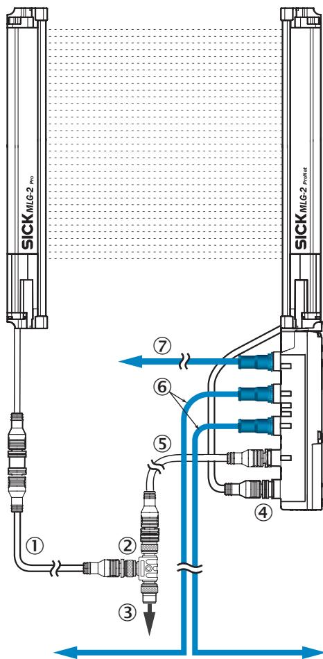
① câble de raccordement émetteur (2096010)
