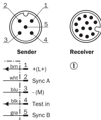
① Raccordement à la boîte de raccordement à bornes (AFB)
