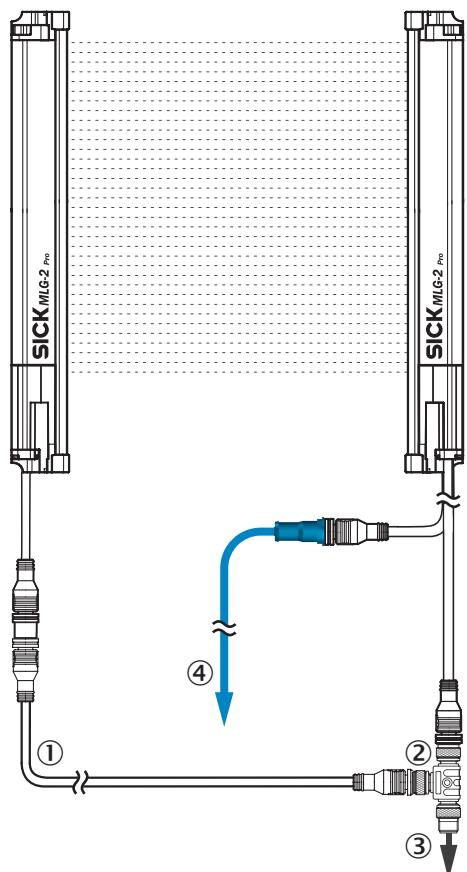
① câble de raccordement émetteur (2096010)
