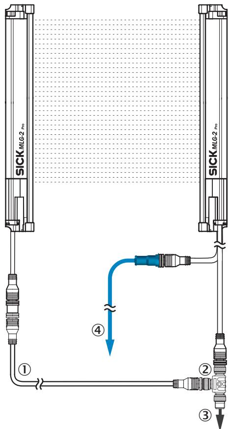
① câble de raccordement émetteur (2096010)
