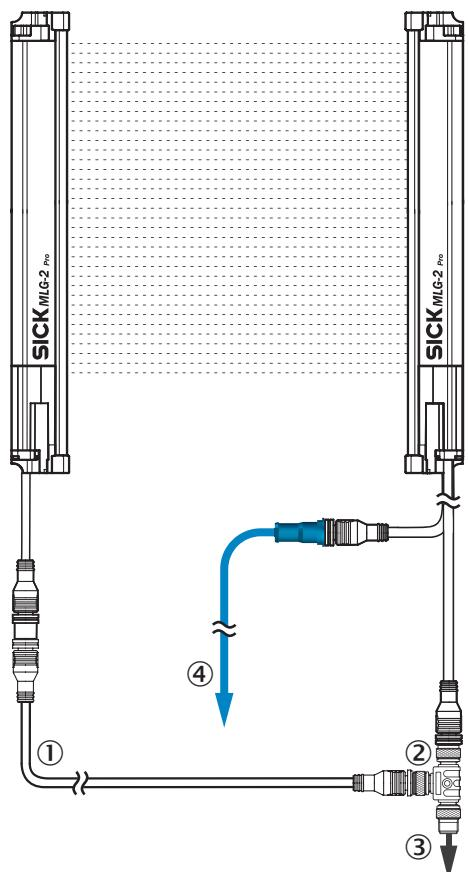
① câble de raccordement émetteur (2096010)
