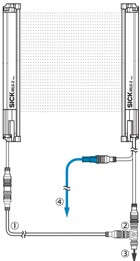
① câble de raccordement émetteur (2096010)
