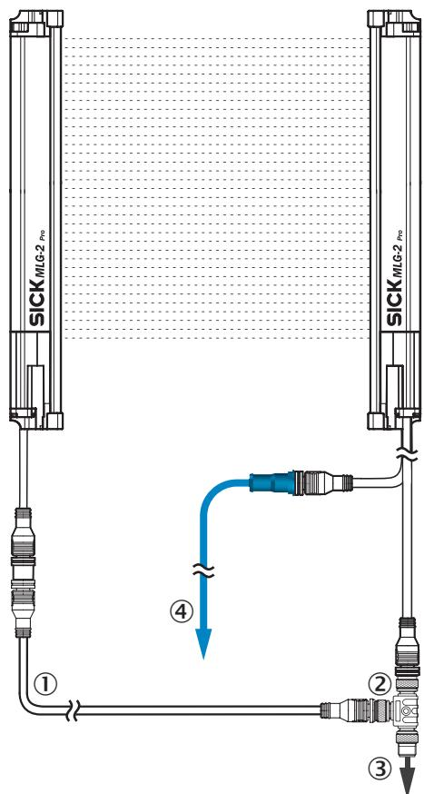
① câble de raccordement émetteur (2096010)
