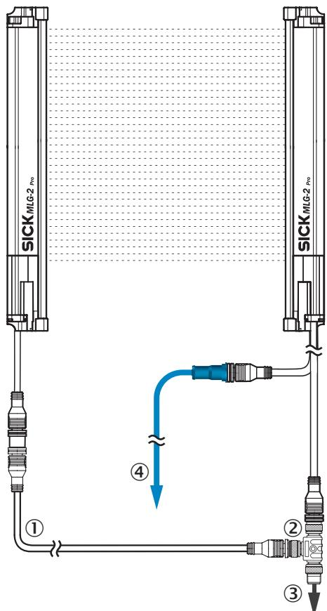
① câble de raccordement émetteur (2096010)
