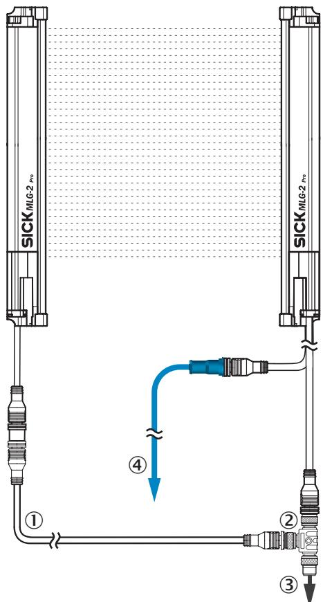
① câble de raccordement émetteur (2096010)
