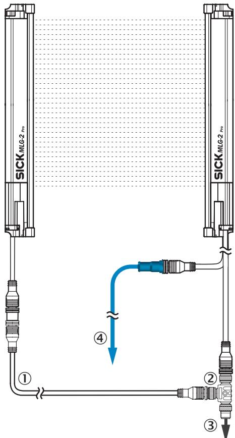
① câble de raccordement émetteur (2096010)
