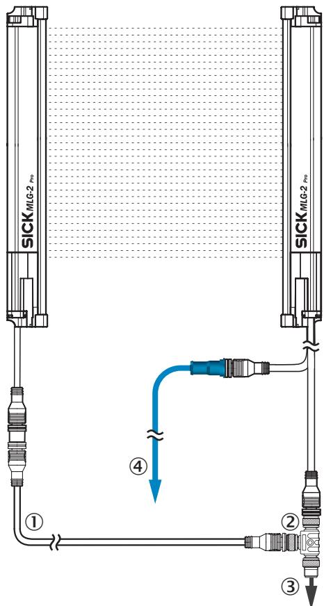
① câble de raccordement émetteur (2096010)
