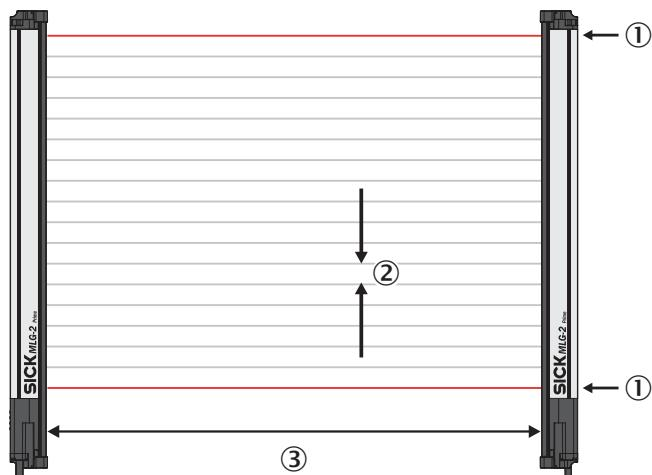
L'émetteur et le récepteur se synchronisent sur la voie optique, aucune connexion électrique n'est donc nécessaire. Pour cela, soit le premier ou alors le dernier faisceau du rideaux d'automatisme doivent rester libres.
