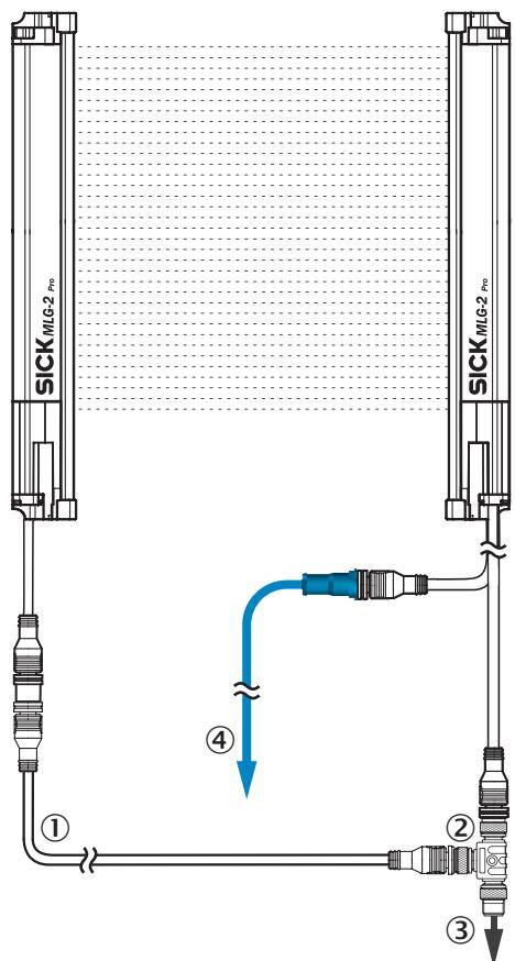
① câble de raccordement émetteur (2096010)
