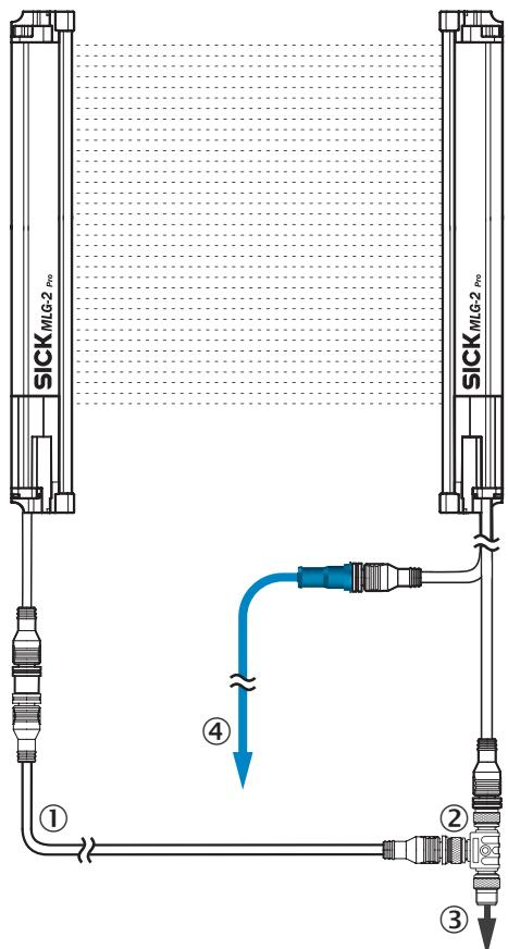
① câble de raccordement émetteur (2096010)
