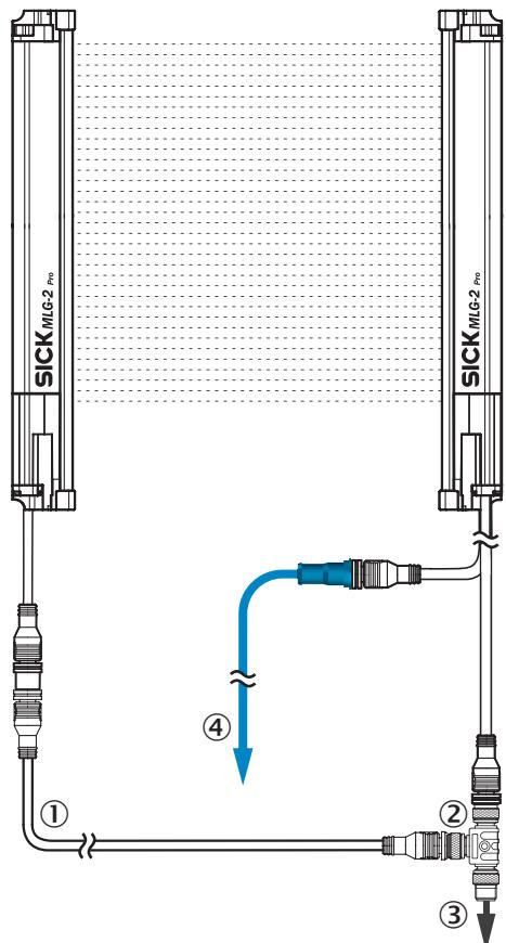
① câble de raccordement émetteur (2096010)
