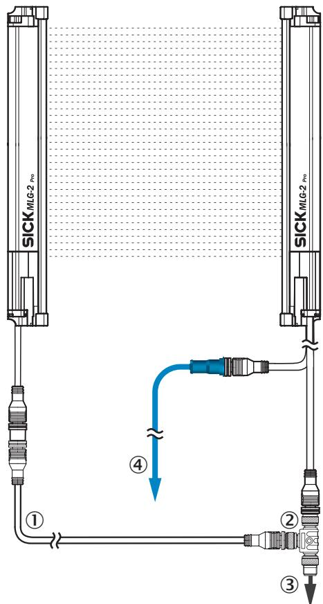
① câble de raccordement émetteur (2096010)
