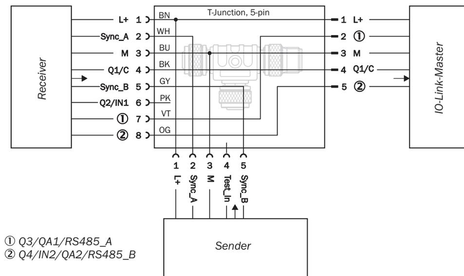
Schéma de raccordement Pièce en T, automate programmable industriel
