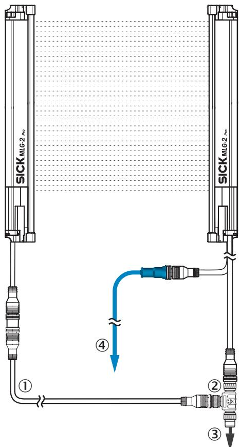
① câble de raccordement émetteur (2096010)
