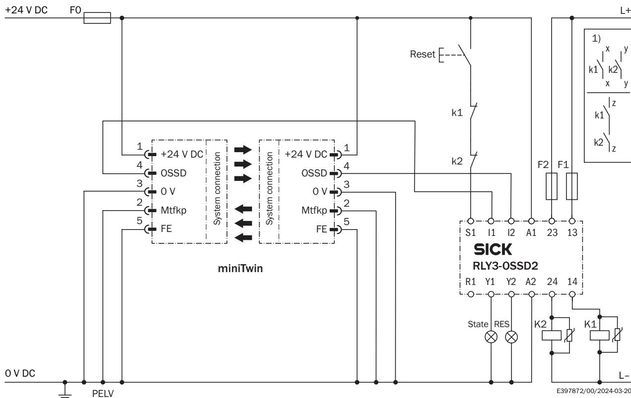
① Circuits de sortie : ces contacts doivent être intégrés dans la commande de manière à ce que lorsque le circuit de sortie est ouvert, la situation dangereuse prenne fin. Pour les catégories 4 et 3, cette intégration doit s'effectuer en double canal (voies x et y). L'insertion en mono canal dans la commande (voie z) n'est possible que pour les commandes en mono canal et après avoir pris en compte l'analyse des risques.
