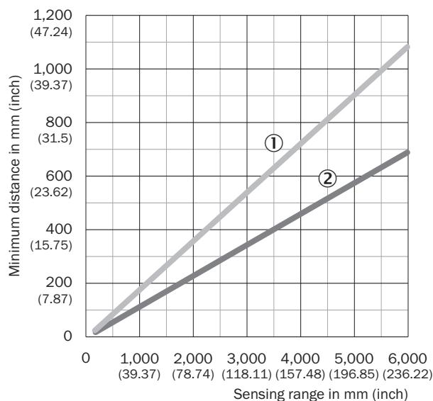
En fonction de la distance de commutation, il faut veiller à ce qu'aucun objet réfléchissant ne se trouve dans le champ de vision de la paire de rideaux de détection
