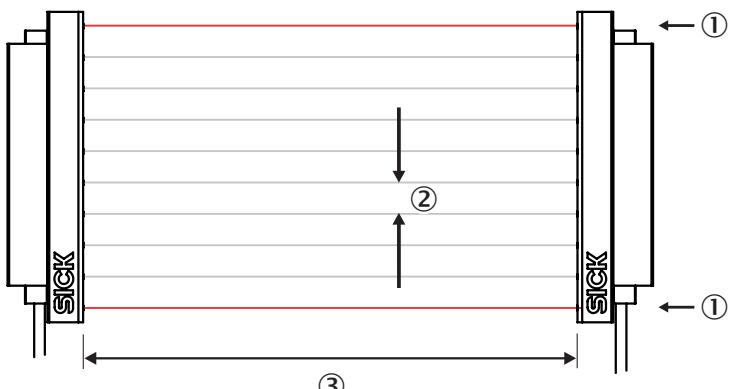
L'émetteur et le récepteur se synchronisent sur la voie optique, aucune connexion électrique n'est donc nécessaire.
