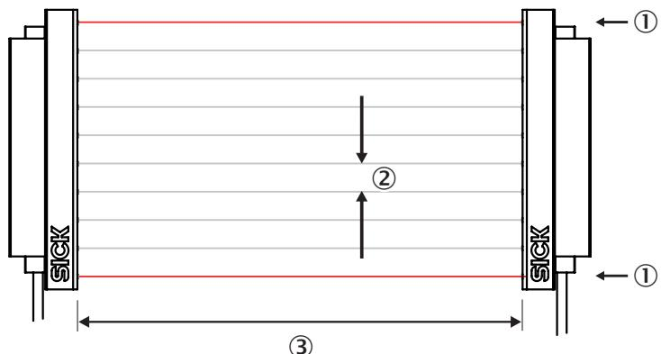
L'émetteur et le récepteur se synchronisent sur la voie optique, aucune connexion électrique n'est donc nécessaire.
