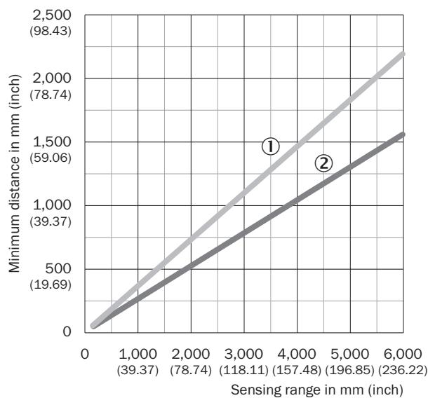
Lors d'une installation qui n'est pas réalisée en sens opposé il faut respecter une distance minimale entre les deux paires de rideaux de détection
