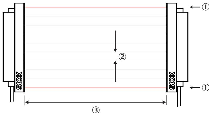
L'émetteur et le récepteur se synchronisent sur la voie optique, aucune connexion électrique n'est donc nécessaire. Pour cela, soit le premier ou alors le dernier faisceau du rideau d'automatisme doivent rester libres. Plus aucune mesure n'est possible si les deux faisceaux sont interrompus.
