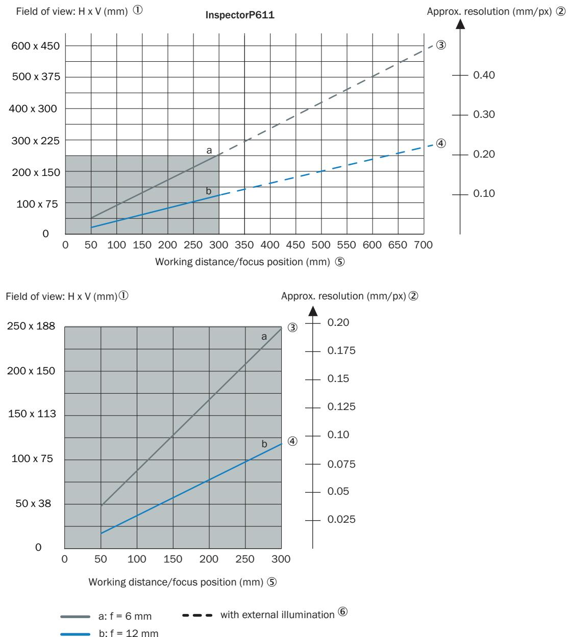
Les aspects suivants doivent être pris en compte lors de la conception de l'application : géométrie du champ de vision de l'appareil et position du champ de vue dans l'espace situé devant l'appareil. Angles possibles sous lesquels les objets peuvent apparaître par rapport à l'appareil. Pour la distance de travail prévue : longueur et largeur de champ de vue résultantes et résolution approximative.
