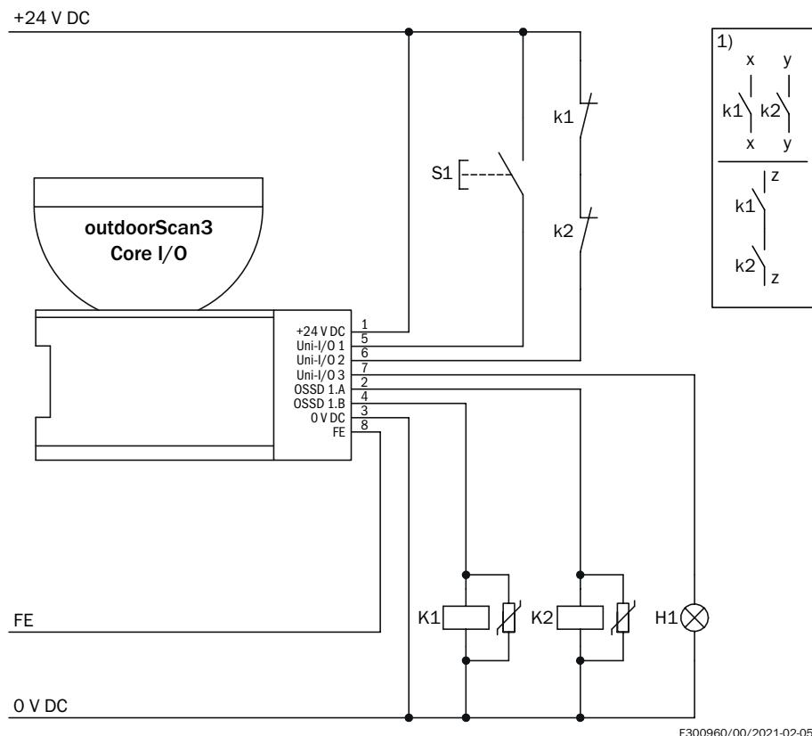
① Circuits de sortie : ces contacts doivent être intégrés dans la commande de manière à ce que lorsque le circuit de sortie est ouvert, la situation dangereuse prenne fin. Pour les catégories 4 et 3, cette intégration doit s'effectuer en double canal (voies x et y). L'insertion en mono canal dans la commande (voie z) n'est possible que pour les commandes en mono canal et après avoir pris en compte l'analyse des risques.
