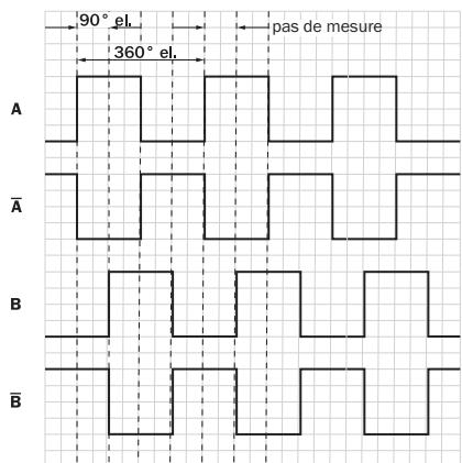
Le pas de mesure correspond à 90° électrique. La résolution spécifiée, par ex. 4 µm, ne peut être atteinte que si un balayage quadruple de la carte de comptage est effectué. Ainsi, chaque front de signal à l'intérieur de la période de 360° él. est compté (montant A, montant B, descendant A, descendant B).
