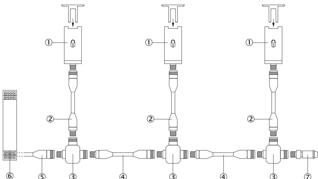
① Interverrouillage de sécurité flexLock
