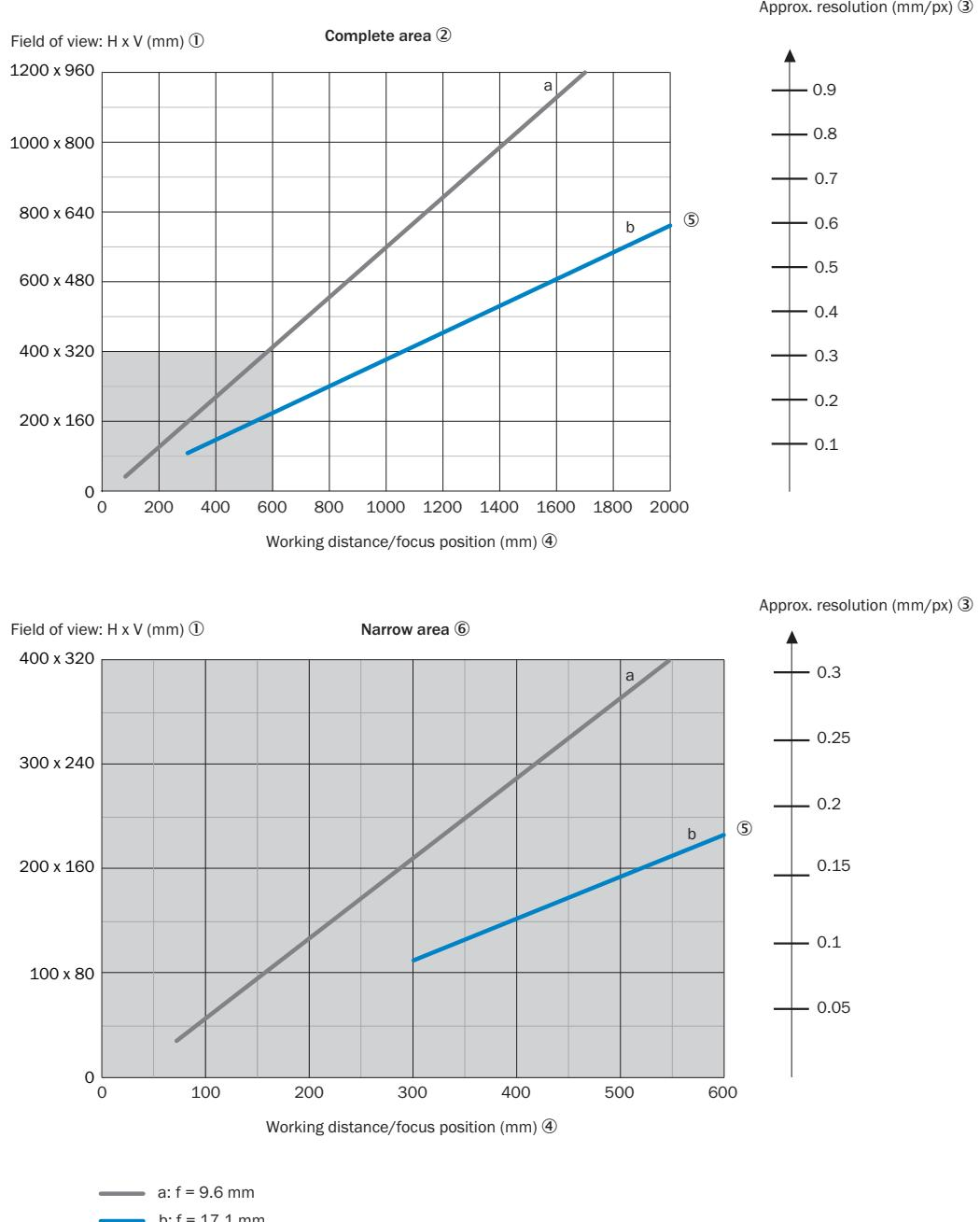
Les aspects suivants doivent être pris en compte lors de la conception de l'application : géométrie du champ de vision de l'appareil et position du champ de vue dans l'espace situé devant l'appareil. Angles possibles sous lesquels les objets peuvent apparaître par rapport à l'appareil. Pour la distance de travail prévue : longueur et largeur de champ de vue résultantes et résolution approximative.
