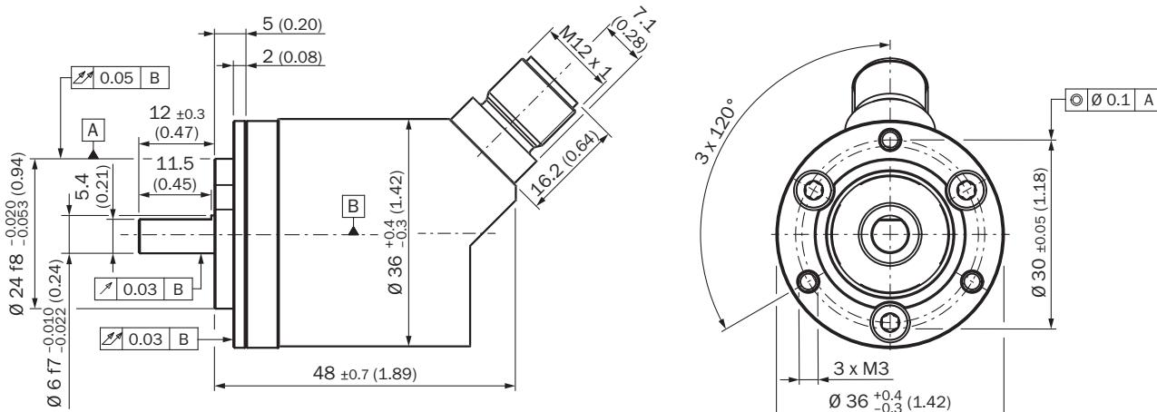
exemple de commande pour diamètre de l'arbre 6 mm : AHx36I-S3xx0xxxx + BEF-FA-020-024-I (adaptateur non prémonté)
