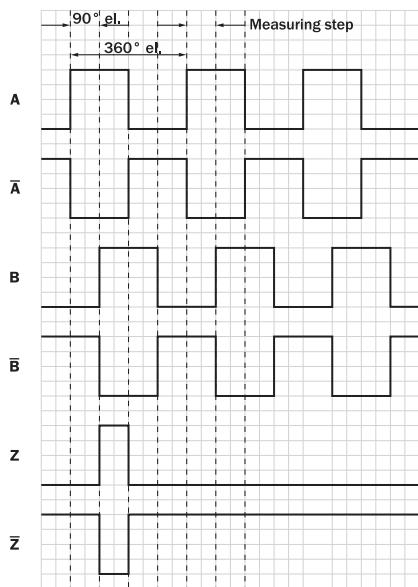
Dans le sens horaire avec vue sur l'arbre de codeur dans la direction « A », voir plan coté.
