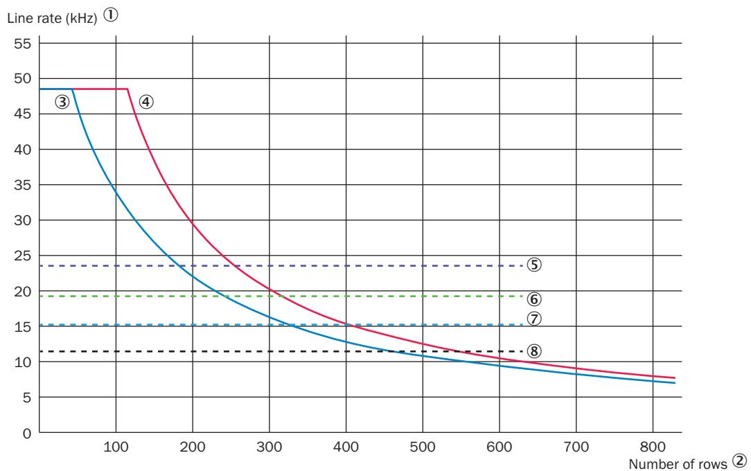
fréquence de ligne maximale en fonction du nombre de lignes de capteurs utilisées
