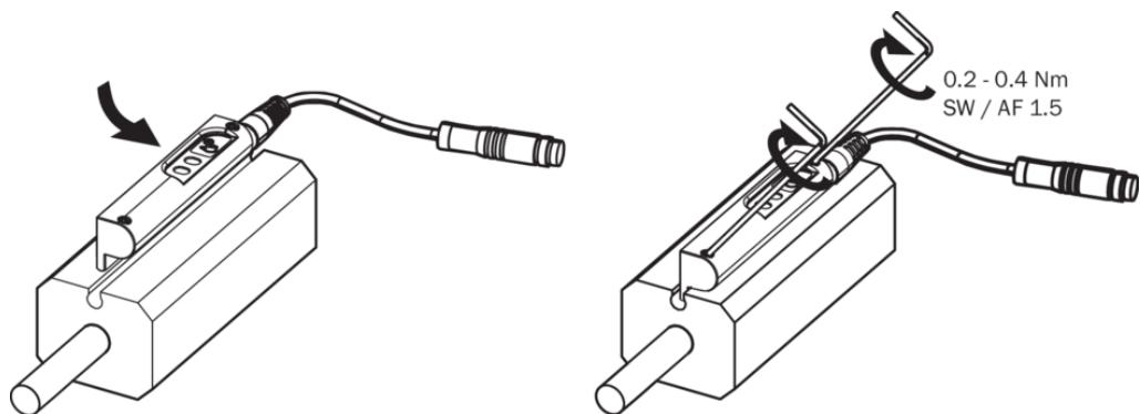
Schéma de raccordement Cd-357
