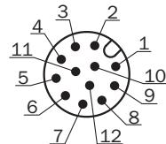
Câble de raccordement avec connecteur mâle ou connecteur mâle M12, 12 pôles, codage A
