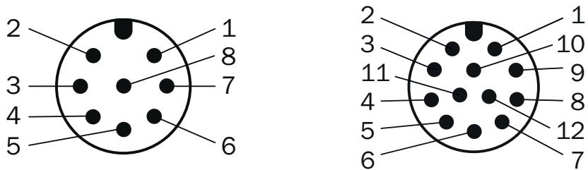
vue connecteur d'appareil M12 sur le codeur
