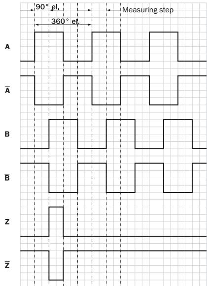
Dans le sens horaire avec vue sur l'arbre de codeur dans la direction « A », voir plan coté.
