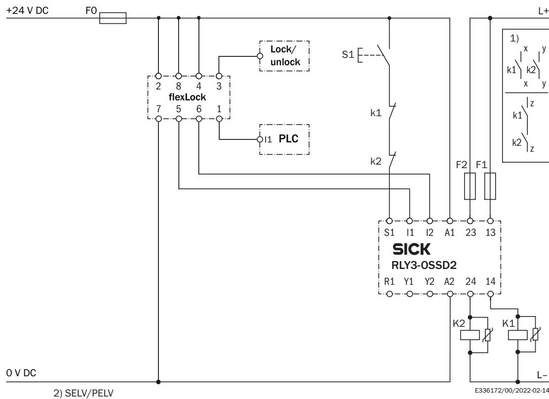
Exemple de câblage Trois interrupteurs de sécurité à interverrouillage flexLock raccordés en série au relais de sécurité RLY3-OSSD2
