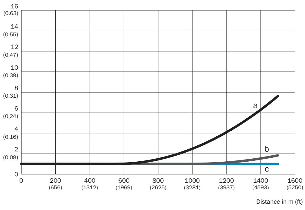
Précision de répétition DL1000 pour différents types de réflecteurs, pour une durée de cycle de mesure de 4 ms
