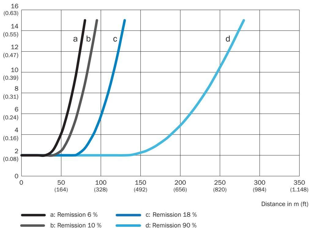
Précision de répétition DT1000, pour une durée de cycle de mesure de 64 ms
