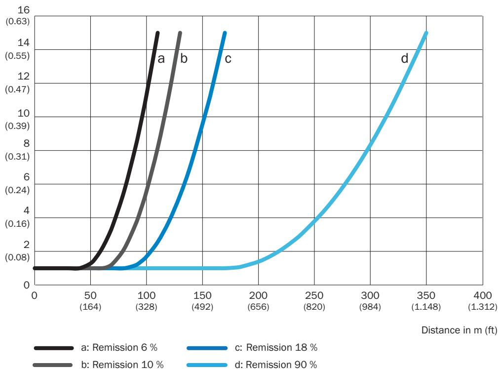
Précision de répétition DT1000, pour une durée de cycle de mesure de 128 ms
