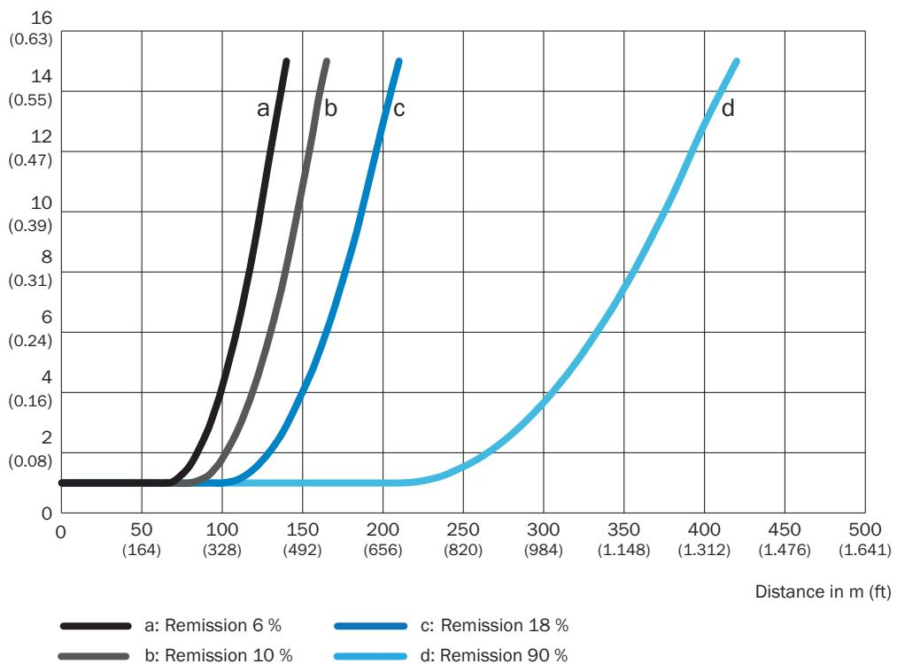
Exactitude de mesure Typiquement DT1000, axe des x : distance, axe des y : exactitude de mesure typ.
